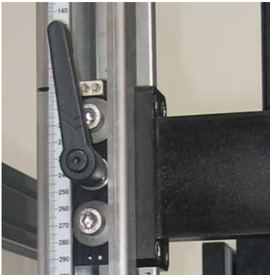
Abbildung 4-2: Schließmechanismus der senkrechten Haltevorrichtung
